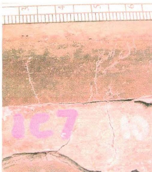
Figura 5 – Exemplos de fraturas de delaminação que desviou e cruzou a superfície interna, com *whiskers* de alumina marcando claramente as trincas.<sup>1</sup>
