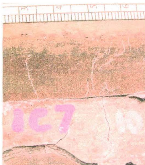
Figura 5 – Exemplos de fraturas de delaminação que desviou e cruzou a superfície interna, com whiskers de alumina marcando claramente as trincas. 1
