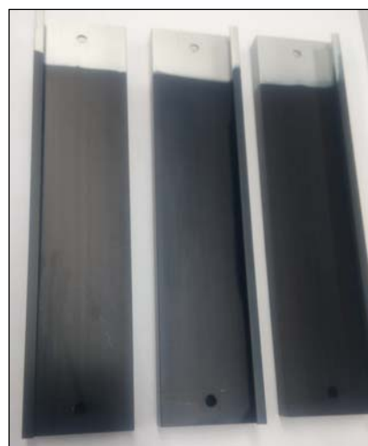
Figura 14. Aparência dos corpos de prova com metodologia de coloração por adsorção orgânica posteriormente 1.000 h de imersão em NaCl 3,5 %.
